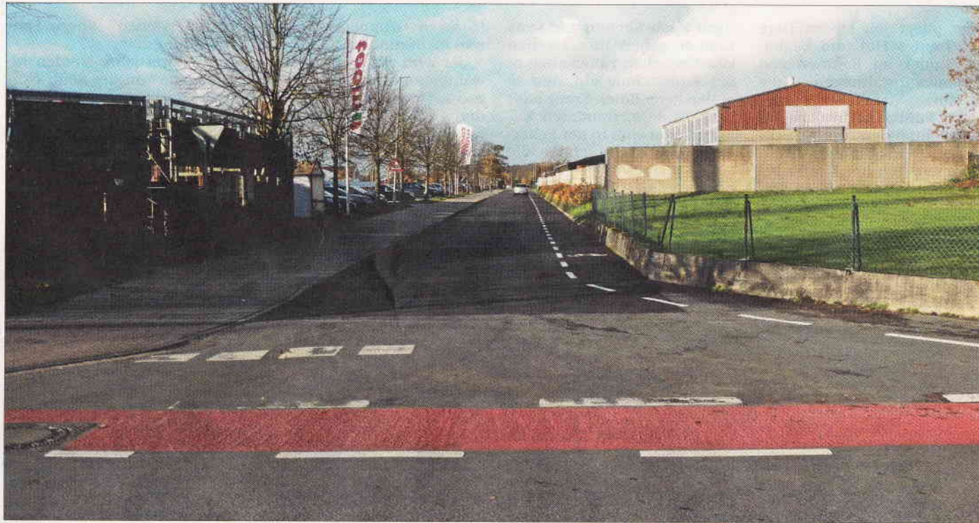
Der Schutzstreifen (gestrichelte weiße Linie) soll das Radeln in der Gewerbestraße in Norden sicherer machen.
